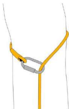
Fig. 2 - Strozzo diretto della fune
