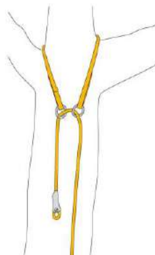
Fig. 8 - Ancoraggio passante per corda raddoppiata
