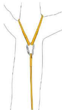
Fig. 5 - Ancoraggio della fune con dispositivo passante
